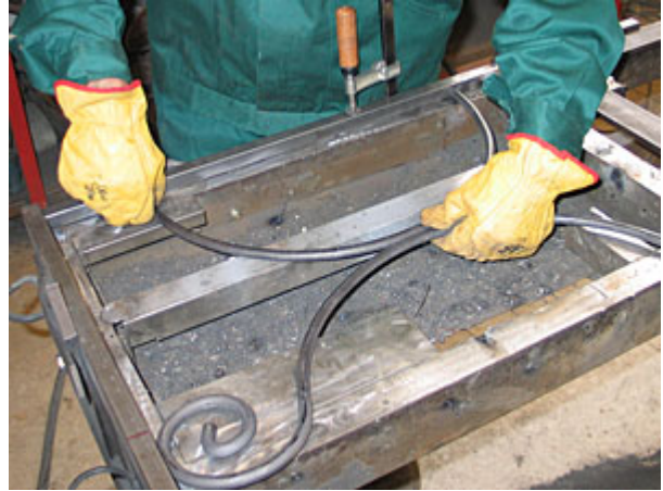
12.- Sobre unos perfiles sujetos con gatos a la mesa en forma de escuadra presentamos las patas.
