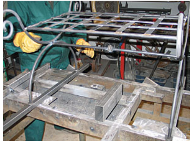
36.- Damos la vuelta al descalzador y presentamos los botones sobre los que asientan las patas
