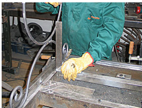
20.- Un primer punto de soldadura y después de igual con el martillo soldaremos la otra cara.
