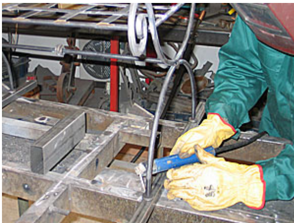
37.- Soldamos las patas a la base, primero un punto en cada pata, después el resto.
