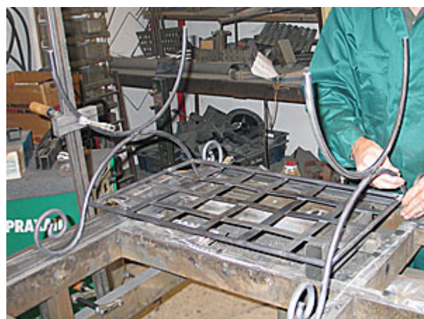
27.- Presenta la otra pata, mide las veces que sea necesario y sujétala antes de soldar.
