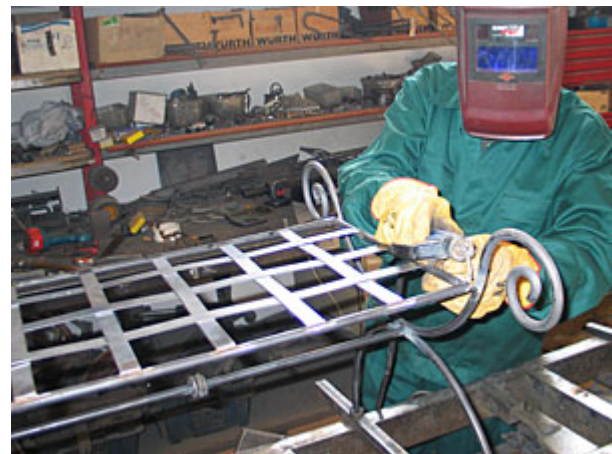
38.- Soldamos bien el asiento bien a las patas, pues sólo tenían un punto
