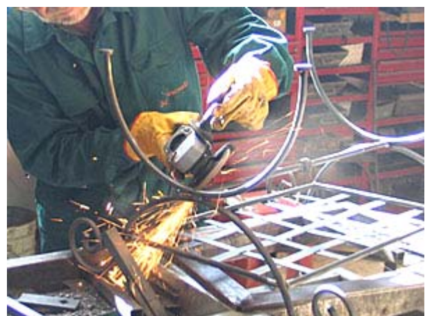
40.- Repasamos todas las soldaduras en el proceso de acabado.
