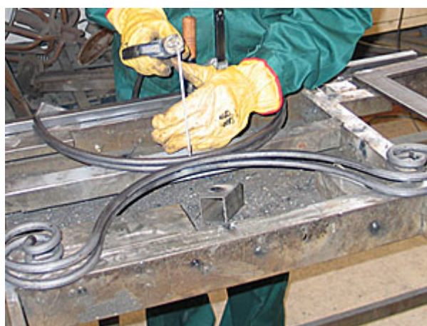
20.- Un primer punto de soldadura y después de igual con el martillo soldaremos la otra cara.
