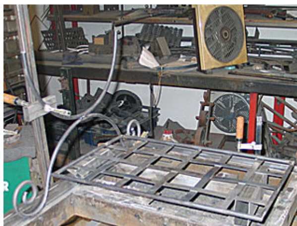
26.- Recuerda que tienes la pieza invertida, coloca correctamente la base del asiento.
