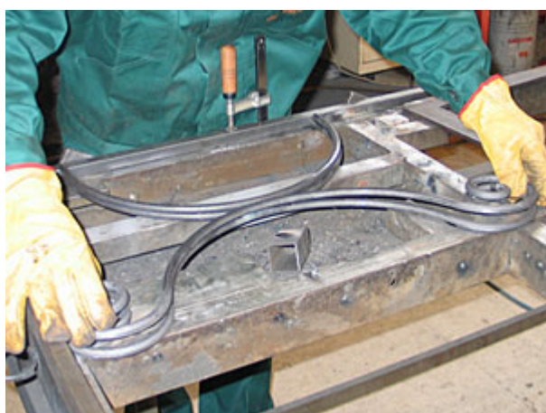
19.- Una vez igualada la utilizaremos como galga para montar la otra pata.
