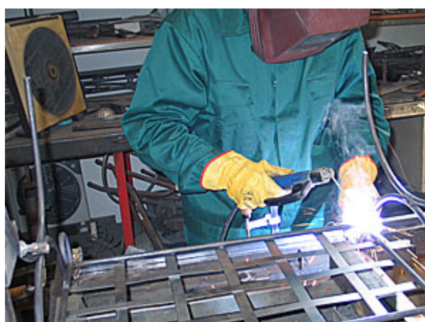
28.- Cuando estés seguro de que está correctamente presentado suelda un punto en cada pata.
