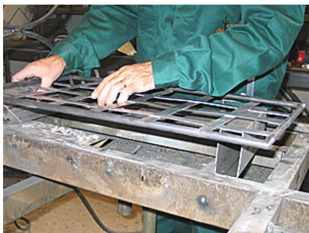
25.- Presentamos el asiento boca abajo. Lo apoyaremos sobre un perfil de 80mm a cada lado.
