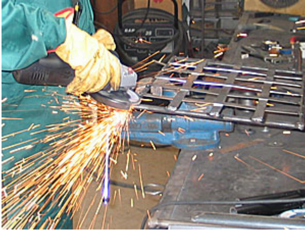
11.- Después de soldar todas las piezas utilizamos la esmeril para repasar toda la base del asiento.
